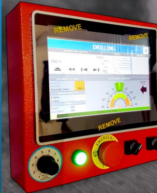
DANK DEM NEUEN TOUCH-SCREEN STEUERUNGSSYSTEM VAPS (VOLUMEK<sup>®</sup> ASSISTED POSITIONING SYSTEM), MIT TOUCHSCREEN PANEL, EINFACH UND INTUITIV, IST ES MÖGLICH, BOHR- UND GEWINDESCHNEIDVORGÄNGE MIT VORHER FESTGELEGTEM MAß DURCHFÜHREN, OHNE DIE NOTWENDIGKEIT VON DER MANUELLEN VERFOLGUNG, WIE BEI TRADITIONELLEN BOHRMASCHINEN.
