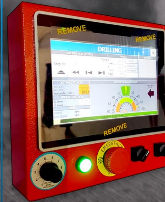
IL NUOVO CONTROLLO VAPS (VOLUME<sup>®</sup> ASSISTED POSITIONING SYSTEM) È UN'INTERFACCIA OPERATORE TOUCH-SCREEN FACILE ED INTUITIVA, CON LA QUALE È POSSIBILE ESEGUIRE OPERAZIONI DI FORATURA E MASCHIATURA ALLE QUOTE PRESTABILITE, SENZA PIU' IL BISOGNO DELLA TRACCIATURA MANUALE COME NEI TRAPANI TRADIZIONALI
