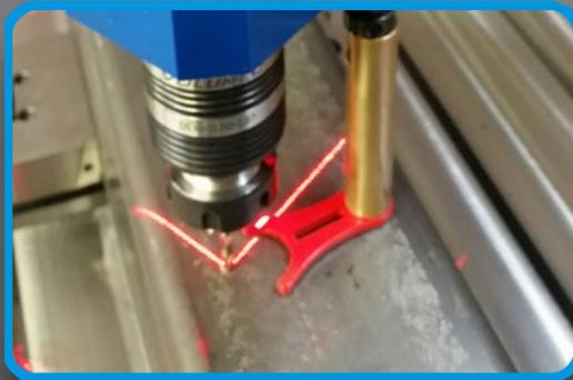
PERMETTE DI IMPOSTARE LA PROFONDITÀ DI FORATURA-MASCHIATURA-SVASATURA DESIDERATA
