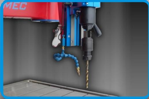
CON QUESTO SISTEMA È POSSIBILE ASSICURARE UNA CORRETTA NEBULIZZAZIONE DIRETTAMENTE SULL'UTENSILE
