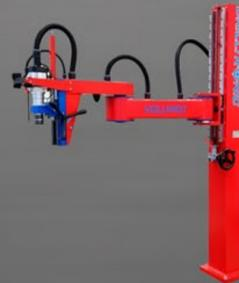
TUTTI I MODELLI DRILLTRONIC POSSONO ESSERE EQUIPAGGIATI CON COLONNA DI SOLLEVAMENTO PREDISPOSTA AL FISSAGGIO A PAVIMENTO.
